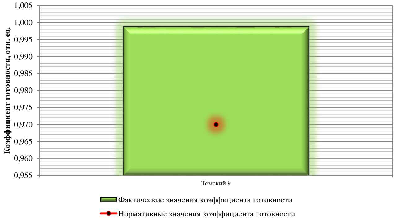
Рисунок 43 – Коэффициент готовности системы к теплоснабжению потребителя
