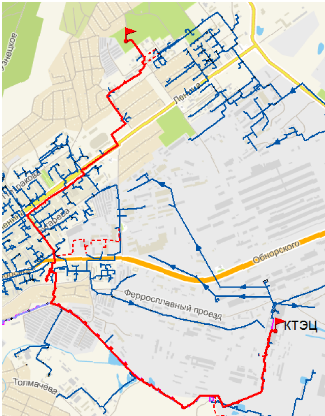
Рисунок 6 – Путь от рассматриваемого теплоисточника до наименее надежного потребителя
