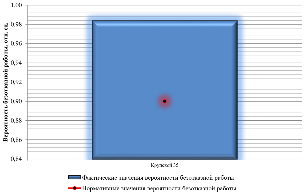
Рисунок 38 – Вероятность безотказного теплоснабжения потребителя в рассматриваемой системе теплоснабжения
