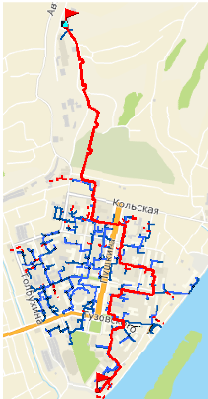
Рисунок 22 – Путь от рассматриваемого теплоисточника до наименее надежного потребителя
