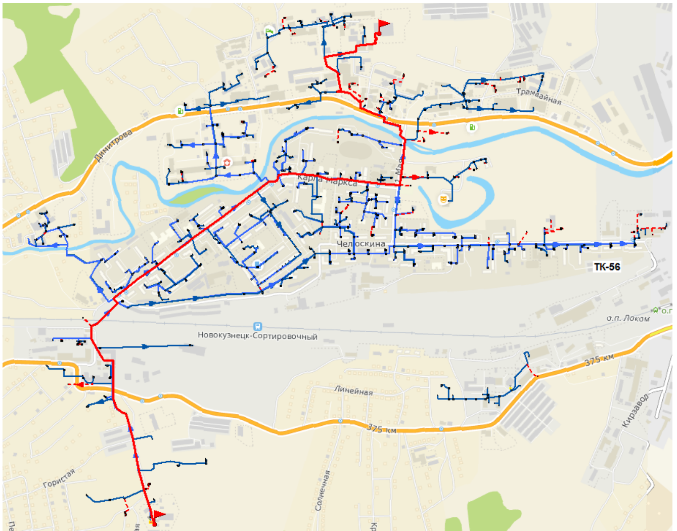
Рисунок 60 – Путь от рассматриваемого теплоисточника до наименее надежного потребителя
