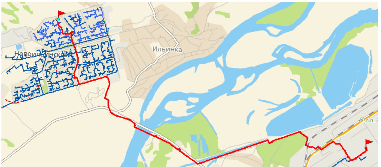
Рисунок 10 – Путь от рассматриваемого теплоисточника до наименее надежного потребителя
