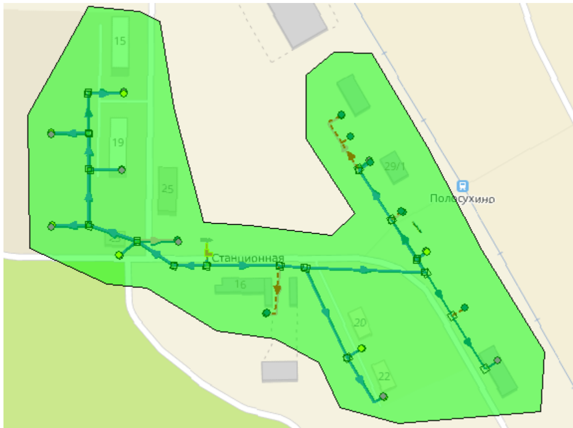
Рисунок 103 – Зоны надежного и ненадежного теплоснабжения от теплоисточника
