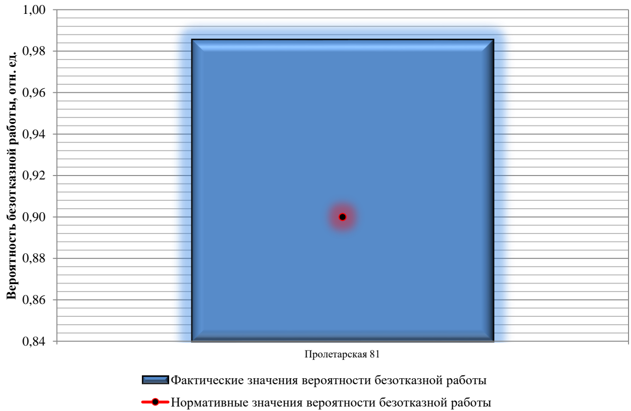
Рисунок 86 – Вероятность безотказного теплоснабжения потребителя в рассматриваемой системе теплоснабжения
