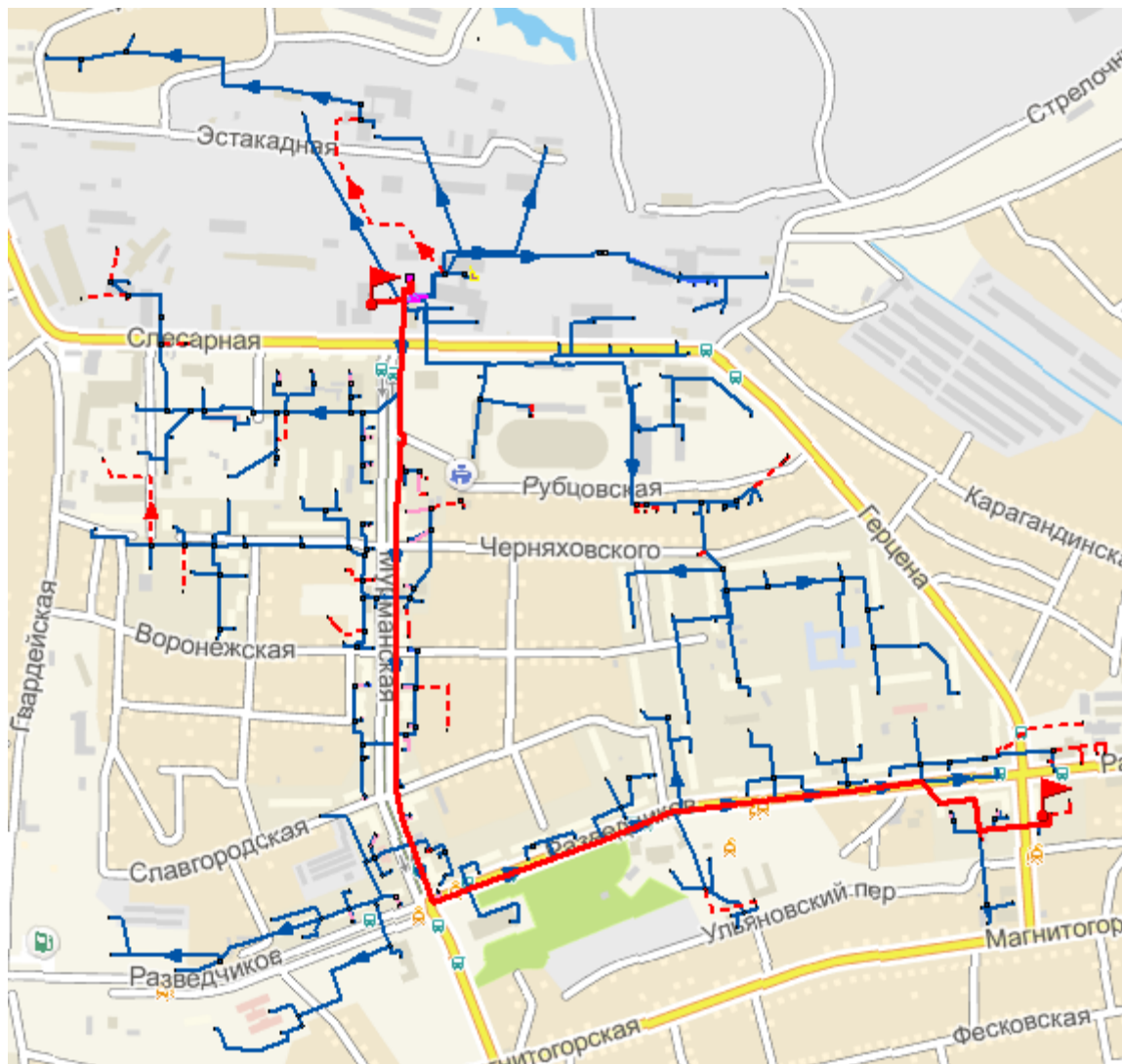
Рисунок 26 – Путь от рассматриваемого теплоисточника до наименее надежного потребителя
