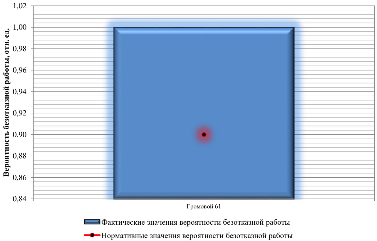
Рисунок 57 – Вероятность безотказного теплоснабжения потребителя в рассматриваемой системе теплоснабжения
