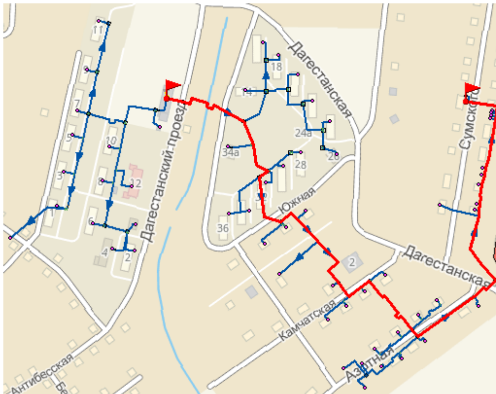
Рисунок 53 – Путь от рассматриваемого теплоисточника до наименее надежного потребителя
