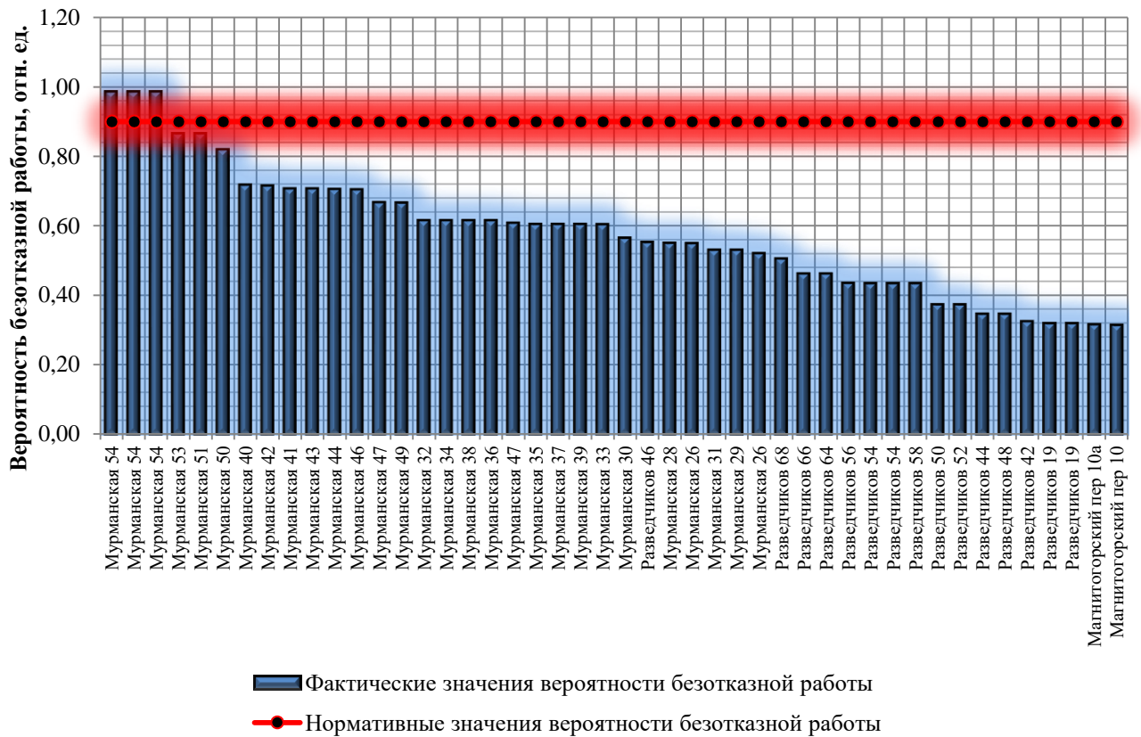
Рисунок 27 – Вероятность безотказного теплоснабжения потребителей в рассматриваемой системе теплоснабжения
